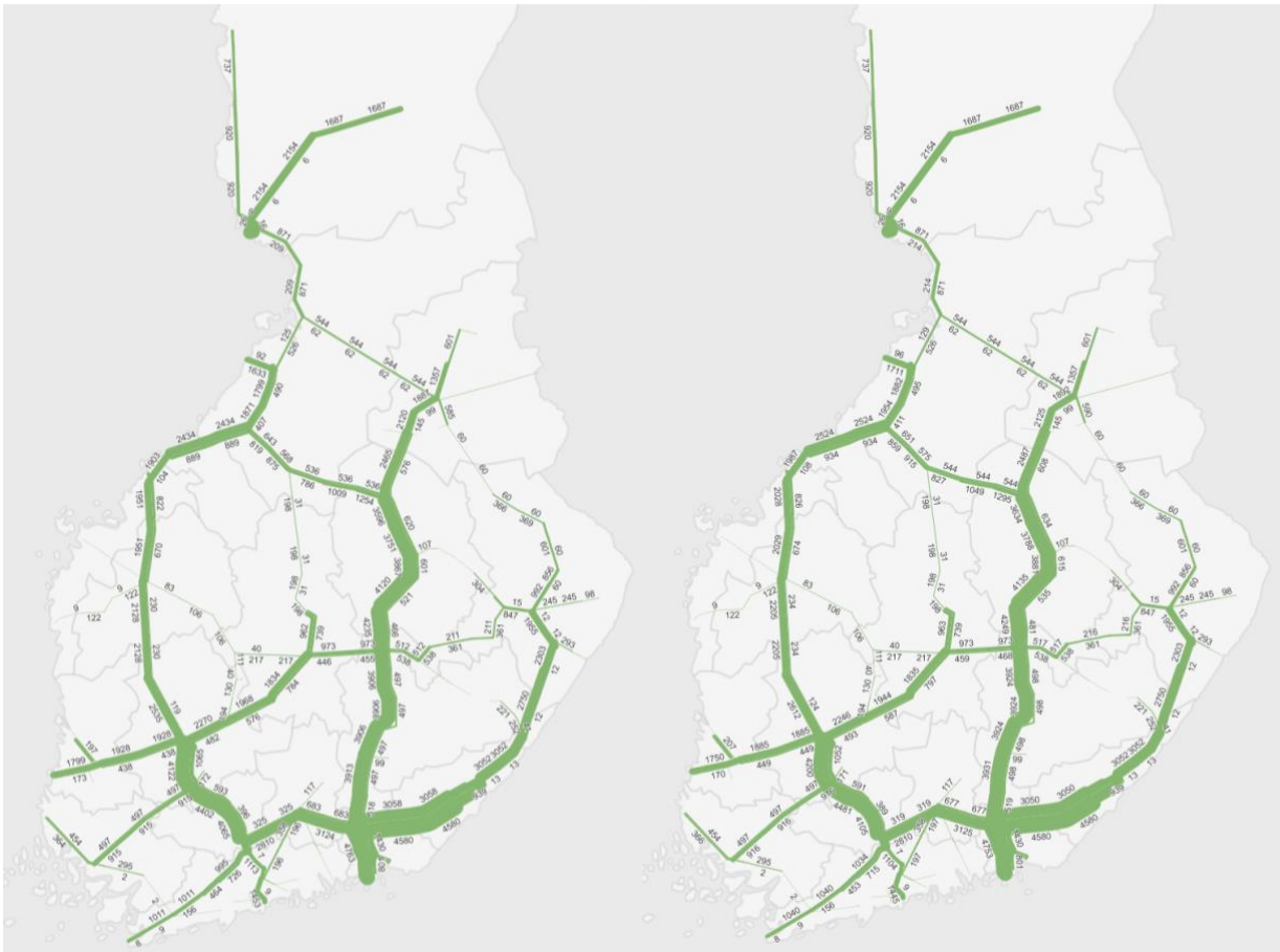
Kuva 15. Valtakunnallisen liikenne-ennusteen rautateiden tavarakuljetusvirrat vuosille (1000 nettotonnia) 2040 ja 2022 liikenne-ennusteen perusteella.
